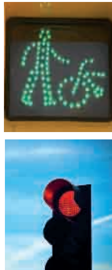
Señales luminosas de tráfico mediante LEDs de emisión en el verde (nitruros) y rojo (arseniuros). A la izquierda, diodo emisor de luz (Light Emitting Diode, LED), sobre matriz de LEDs emitiendo luz blanca.
