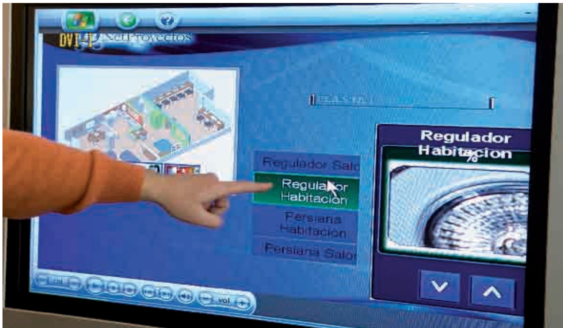
Interfaz accesible, mediante TV y ordenador, para control domótico centralizado.
