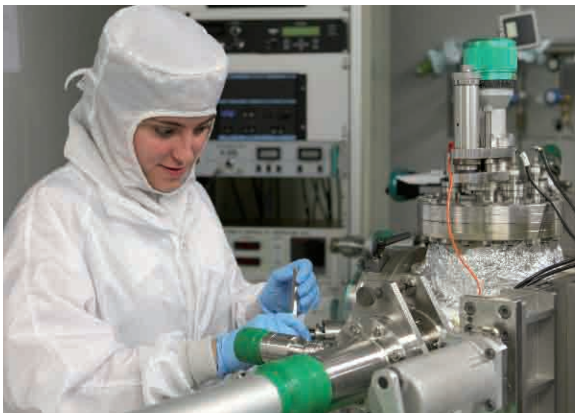
Investigadora del ISOM manejando el sistema de introducción de muestras al sistema MBE.
