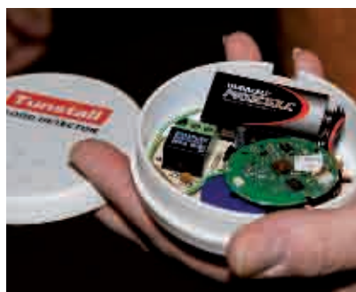
Sensor inalámbrico de inundación para teleasistencia accesible.
